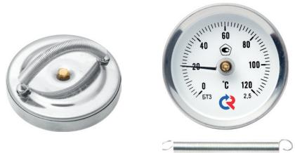
Корпус: коррозионностойкая сталь ■ IP43 ■ Стекло: минеральное ■ Чувствительный элемент: биметаллическая спираль ■ Температура окружающей среды: 0...+60 °C ■ Присоединение: стальная спиральная пружина для крепления на трубе (диаметр от 20 до 50 мм)
