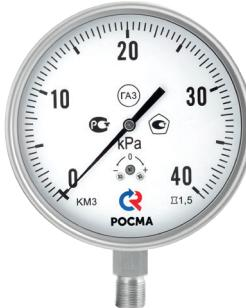
Корпус, механизм, чувствительный элемент и штуцер: нержавеющая сталь ■ IP54, IP65 ■ Стекло: минеральное ■ Температура измеряемой среды: до +100 °C
